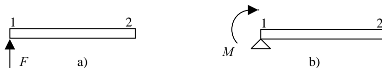
Figura 1 – Exemplos de disposição de vigas para determinação das expressões de mobilidade
